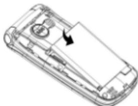
Coloque novamente a tampa traseira. Ouvirá um clique quando instalada.
